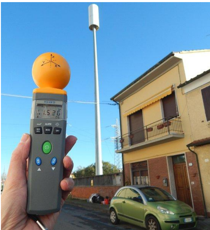
Una misurazione del campo vicino a un'antenna della telefonia mobile.
